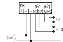
Commande de la lumière en fonction de la présence et de la luminosité ainsi qu'une commande CVC en fonction de la présence. La valeur de luminosité peut être sortie comme résistance variable au lieu du relais 1.
