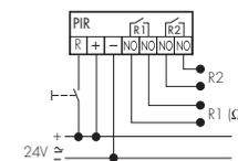
Une entrée Remote séparée (R) permet d'allumer resp. éteindre manuellement la lumière si besoin.
